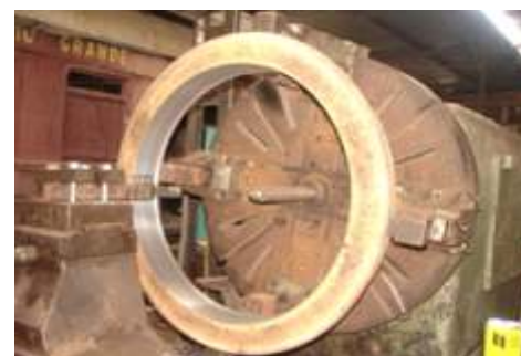
Em usinagem os novos aros, o primeiro com a castanha nova e segundo ainda com as castanhas antigas
