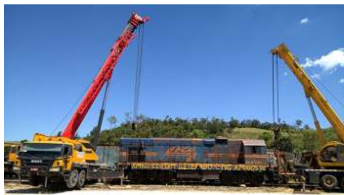
Içamento da 4190 para ser colocada sobre a carreta
