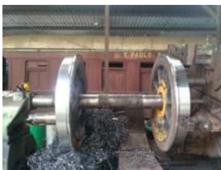
Muitas horas de usinagem e finalmente os quatro rodeiros estão com friso e o ângulo da bandagem todos iguais
