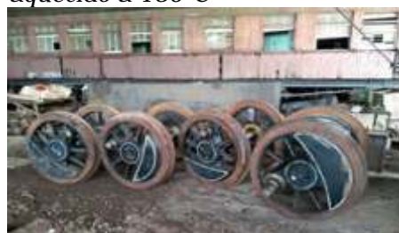
Já montadas todos os quatro rodeiros e as novas castanhas confeccionadas para esta usinagem
