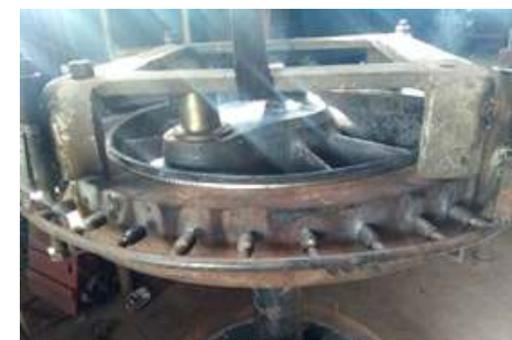
Usinagem da roda que se encontrava oval e instalação do primeiro aro aquecido a 180°C
