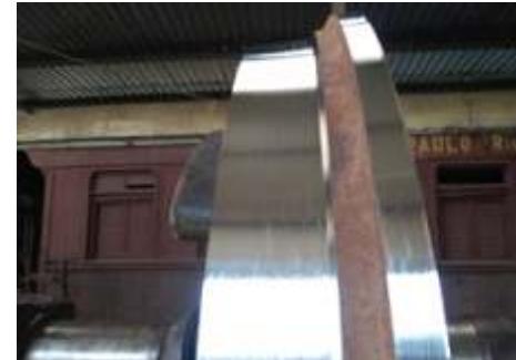
Início dos trabalhos de usinagem nas rodas para formar o ângulo do friso e da bandagem
