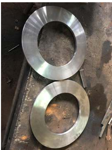
Confeção dos discos da lateral dos mancais e uma das três telhas usinadas para substituir as quebradas
