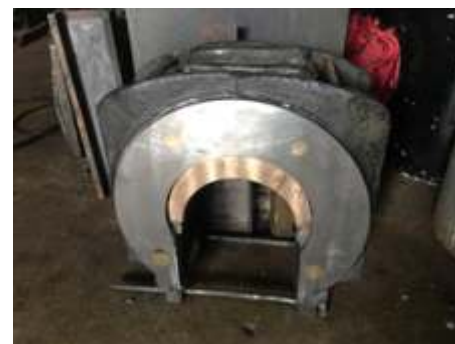
Trabalho de usinagem em fresa na recuperação e revisão geral dos mancais da locomotiva Mikado nº 1424
