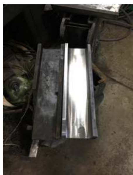
Confeção dos discos da lateral dos mancais e uma das três telhas usinadas para substituir as quebradas
