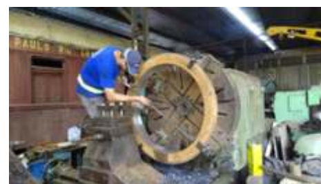
Os antigos aros já retirados e no torno de roda o aro novo, sendo usinado no diâmetro das rodas
