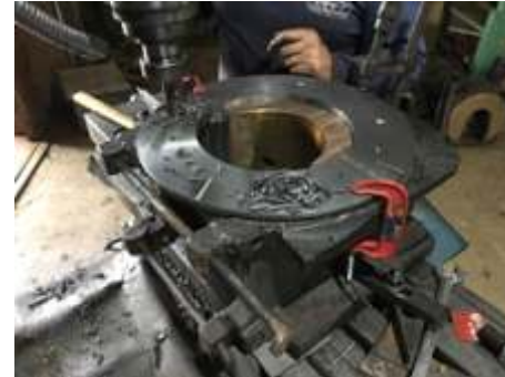
Trabalho de usinagem em fresa na recuperação e revisão geral dos mancais da locomotiva Mikado nº 1424
