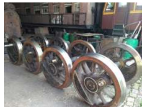
Muitas horas de usinagem e finalmente os quatro rodeiros estão com friso e o ângulo da bandagem todos iguais
