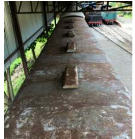
Preparação para pintura do teto do carro que estava em Pouso Alegre
