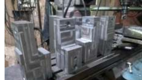
Já montadas todos os quatro rodeiros e as novas castanhas confeccionadas para esta usinagem
