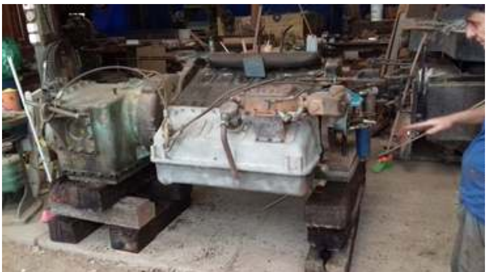
Motor da litorina sendo preparado para funcionar em Carlos Gomes
