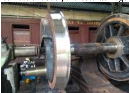
Início dos trabalhos de usinagem nas rodas para formar o ângulo do friso e da bandagem
