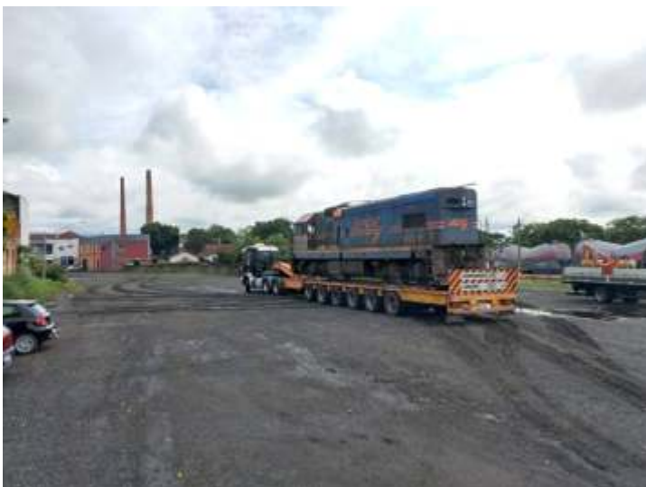
Manobras para posicionar a carreta na direção da rampa para a 4190 desembarcar
