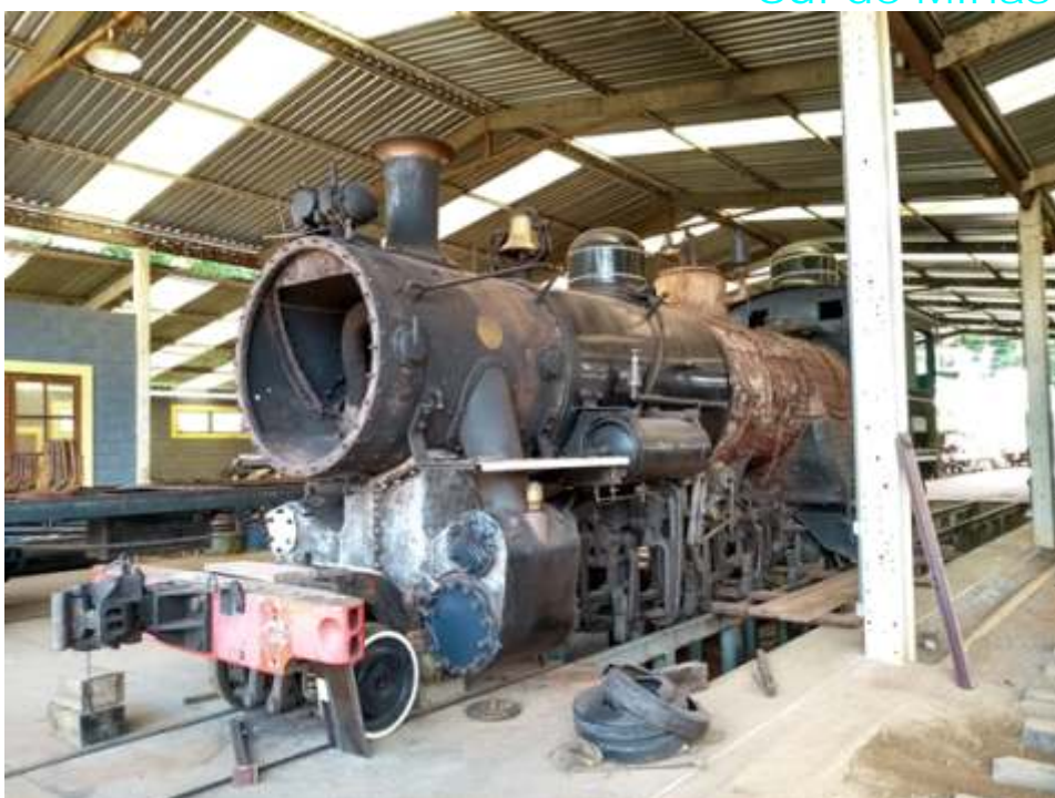
Nas oficinas de São Lourenço, estão sendo realizados os serviços de manutenção da caldeira e preparação para nova pintura
